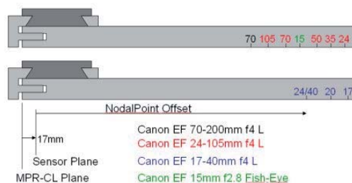
Really Right Stuff MPR-CL Schiene mit verschiedenen Nodalpunkten
