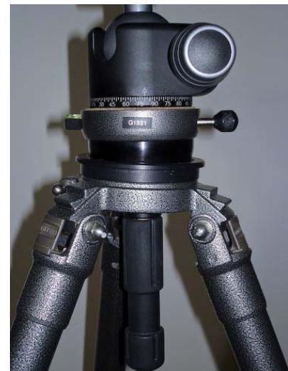
Links: Wasserwagen auf Stativ, Nivelliereinheit und Kugelkopf, Rechts: Nivelliereinheit Gitzo G1321 auf Stativ
