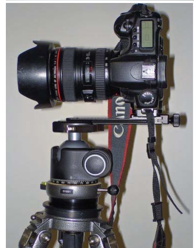
Oben: Panoramaschiene MPR-CL. Unten: Montierung auf Kugelkopf und Nivelliereinheit
