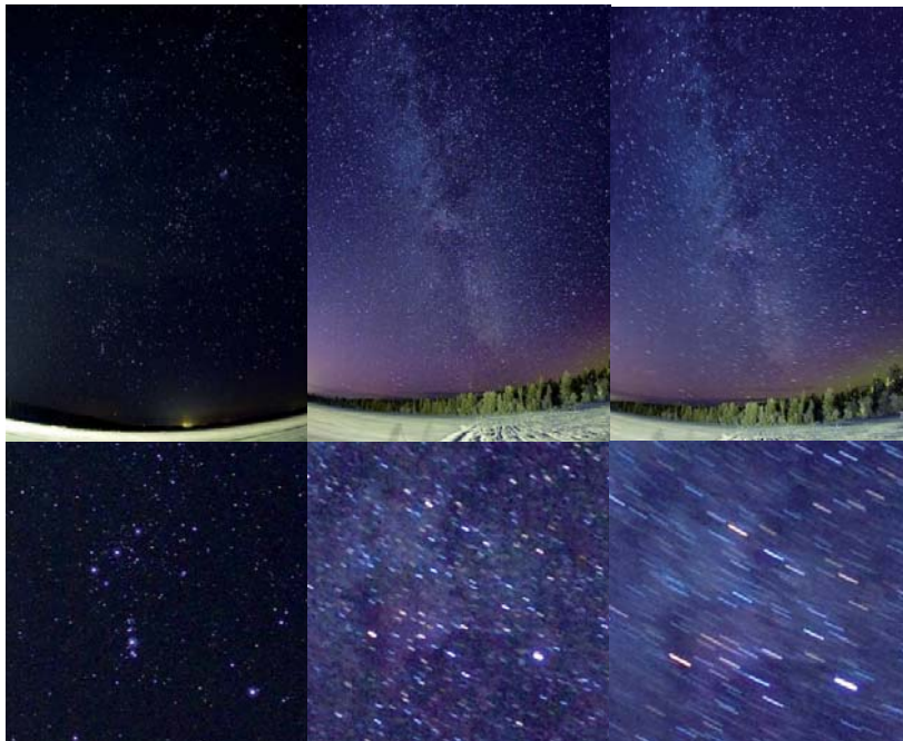
Verschiedene Belichtungen mit 800ASA, 15mm Fish-Eye, 1: 20sec, 2: 58sec, 3: 188sec, untere Reihe: 100% Auschnitte, nur die 20 sec. Aufnahme bildet die Sterne scharf ab ,APS-C Sensor, Canon 20D, 8.2MP
