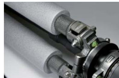
Die oberen Beinelemente des Stativs werden mit Schaumstoffrohren versehen, Details s. Text
