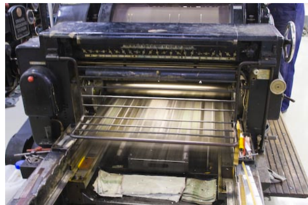
Die Schnelldruckpresse: Links: Übersicht, Rechts: der Schlitten wird gerade wieder in die Urposition gefahren, oben sieht man die Rotationswalze
