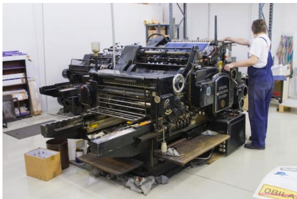
Die Schnelldruckpresse: Links: Übersicht, Rechts: der Schlitten wird gerade wieder in die Urposition gefahren, oben sieht man die Rotationswalze
