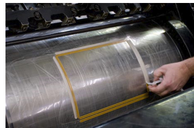
Nach einem Durchlauf kleben die Rillnuten auf der Walze, man muss nur noch die Gumminuten entfernen.
