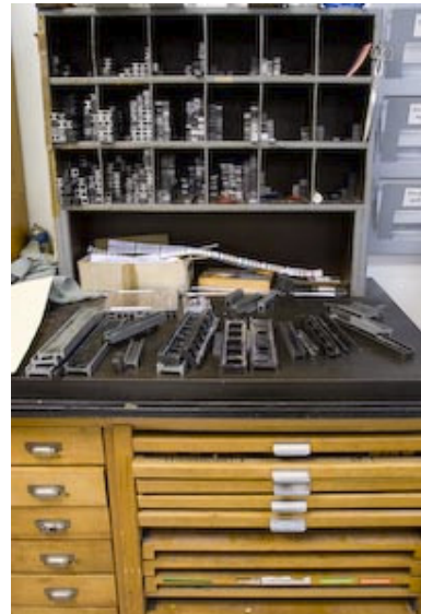
Links: Prägestempel für die Mappenrückseite (Vordergrund) und die Mappenvorder-
