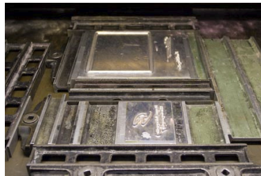
Links: Prägestempel für die Mappenrückseite (Vordergrund) und die Mappenvorder-
