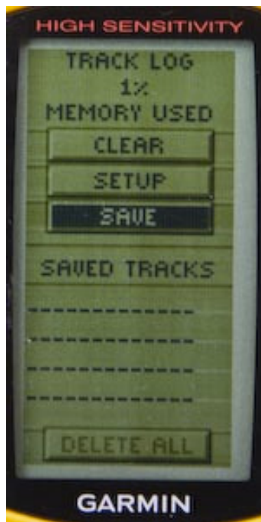
Links: Prozentuale Anzeige des Füllstandes des Track-Speichers, Rechts: Vorgaben für die Track Datenspeicherung, hier alle 20m zeitunabhängig
