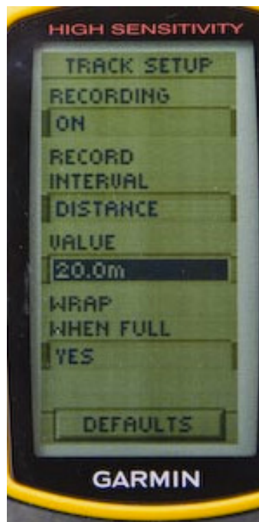
Links: Prozentuale Anzeige des Füllstandes des Track-Speichers, Rechts: Vorgaben für die Track Datenspeicherung, hier alle 20m zeitunabhängig
