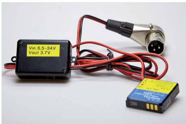
AC/DC Konverter mit Dreipoladapter und Batterieadapter, rechts ist der AC/DC Konverter Chip sichtbar, Details s. Text
